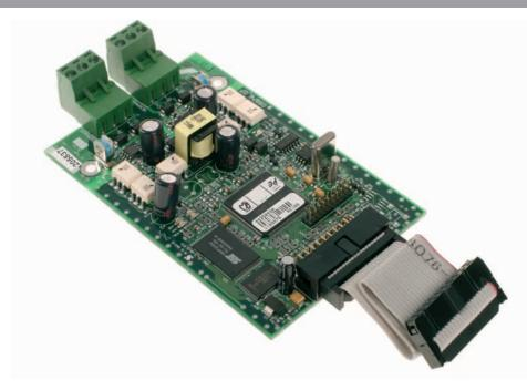
VESDAnet™ (Scheda VN) è una scheda di interfaccia semplice per i rilevatori di fumo VESDA della serie VLF. Assicura la regolare comunicazione, tramite VESDAnet, dal rilevatore agli altri dispositivi, fra cui i tool di configurazione e monitoraggio.
