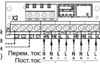
Подключение рабочего напряжения
