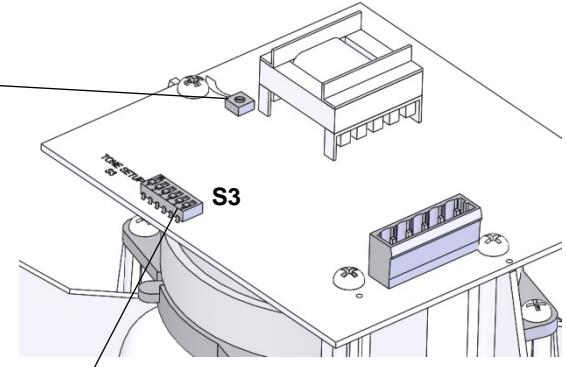
Необходимый звуковой тон можно выбрать с помощью переключателя звуковых тонов S3. После подачи напряжения питания генерируется звуковой тон. Полная таблица звуковых тонов находится в приложении. Для внешнего управления другими звуковыми тонами смотри цифровое руководство по эксплуатации, источник: [www.pfannenberg.com/manuals](http://www.pfannenberg.com/manuals)
