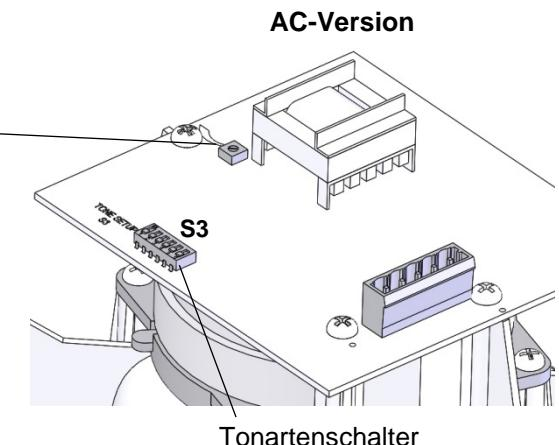
Der gewünschte Ton wird mit dem Tonartenschalter **S3** ausgewählt. Nach Anlegen der Versorgungsspannung wird der Ton erzeugt. Eine vollständige Tonartentabelle befindet sich im Anhang. Für die externe Ansteuerung der Töne siehe digitale Betriebsanleitung, Quelle: [www.pfannenberg.com/manuals](http://www.pfannenberg.com/manuals)
