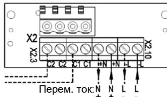
Подключение рабочего напряжения
