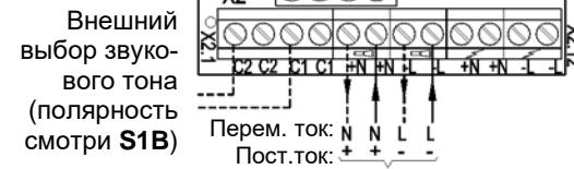
Подключение рабочего напряжения
