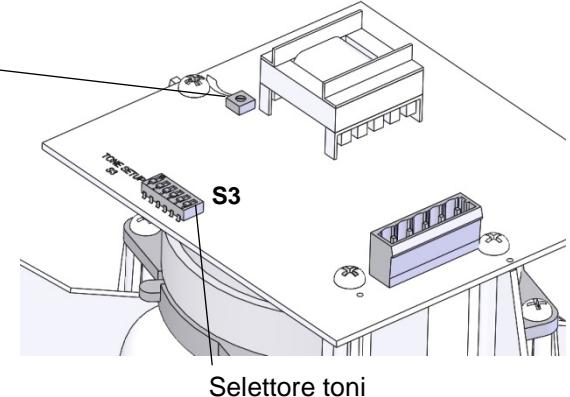
Il selettore **S3** permette di selezionare il tono desiderato. Il tono viene emesso una volta attivata la tensione di alimentazione. La tabella toni allegata riporta l'elenco completo di tutti i toni. Per il controllo esterno di altri toni, fare riferimento al manuale d'uso in formato digitale: [www.pfannenberg.com/manuals](http://www.pfannenberg.com/manuals)
